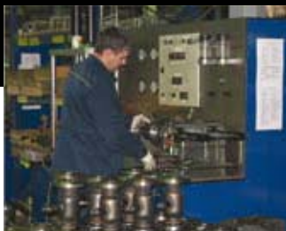
Тестирование шаровых кранов
