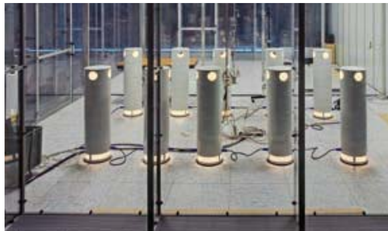
Испытательная камера для тепло- и холодопроизводительности
