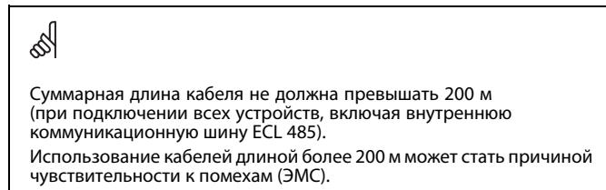
Суммарная длина кабеля не должна превышать 200 м (при подключении всех устройств, включая внутреннюю коммуникационную шину ECL 485).
