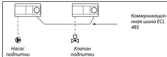
При установленном значении ВЫК, если возникает необходимость подпитки, регулятор соответствующего контура посылает запрос на ведущий регулятор посредством коммуникационной шины ECL 485.
