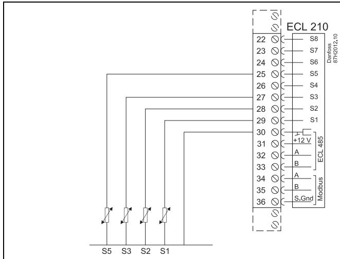
\* Если датчик температуры наружного воздуха не подключен, или в кабеле произошло короткое замыкание, регулятор считает температуру наружного воздуха равной 0 (ноль) °C.
