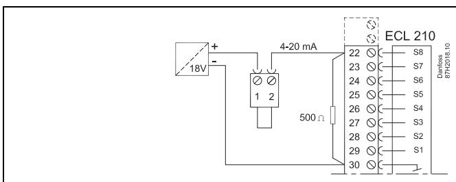
**Подключение реле давления**
