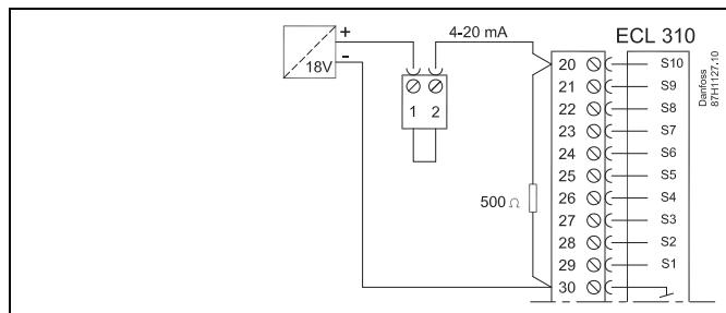
**Подключение реле давления**
