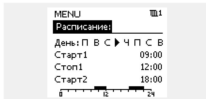
График показывает время начала и окончания комфорtnого периода (контур отопления и контур ГВС) для каждого дня недели.
