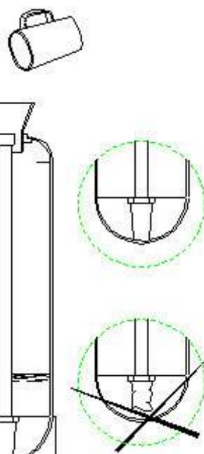
Полностью (до упора) закрутить блок управления в корпус и повернуть пустой фильтр так, чтобы блок управления был ориентирован в направлении, удобном для монтажа и эксплуатации фильтра.
