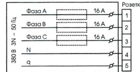
Рис. 2. Схема подключения розетки к стационарной электросети
