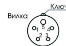
Рис. 3. Схема контактов на вилке
