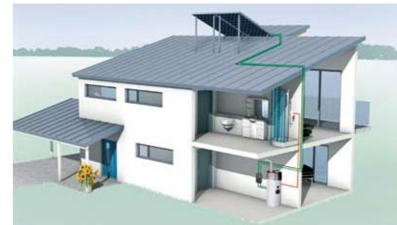
Солнечные коллекторы для приготовления горячей воды в сочетании с тепловым насосом для горячего водоснабжения BWP 30HLW или AWP 30HLW
