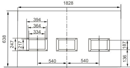
Схема расположения отверстий для болтов крепления воздуховода выпускного отверстия KSTU560HFAN1
