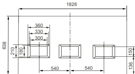
Схема расположения отверстий для болтов крепления воздуховода воздуховыпускного отверстия KSTU440HFAN1
