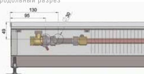
Базовый тип внутрипольного конвектора с естественной конвекцией самой мощной серии PMW.
