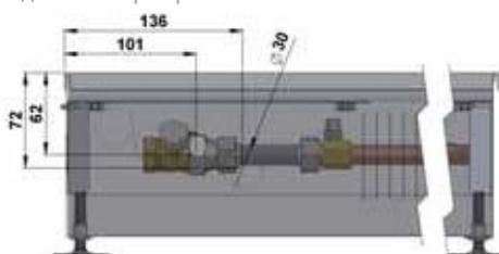
Базовый тип внутрипольного конвектора стандартной ширины с естественной конвекцией серии PT.
