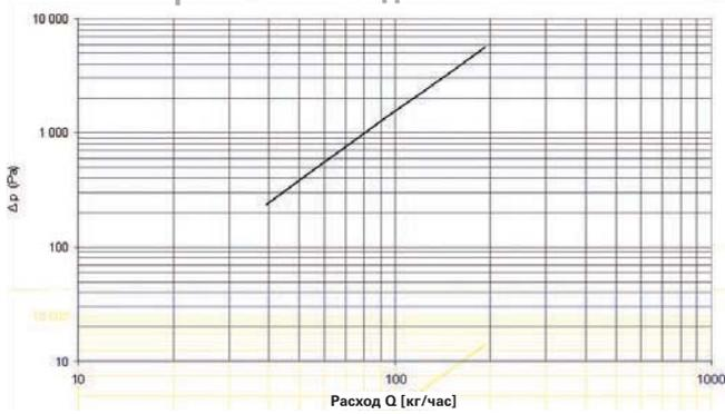
Потеря давления в регулировочном угловом резьбовом соединении 3/8"
