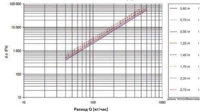
Потеря давления в резьбовом соединении и теплообменниках присоединения 1/2"
