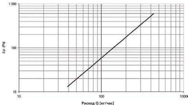
Потеря давления в восьмитрубчатом теплообменнике MINIB трубка Cu Ø 15 мм
