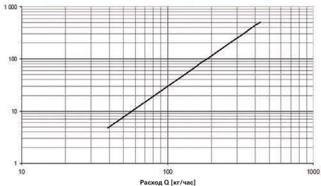
Потеря давления в регулировочном прямом резьбовом соединении ARCO 1/2"
