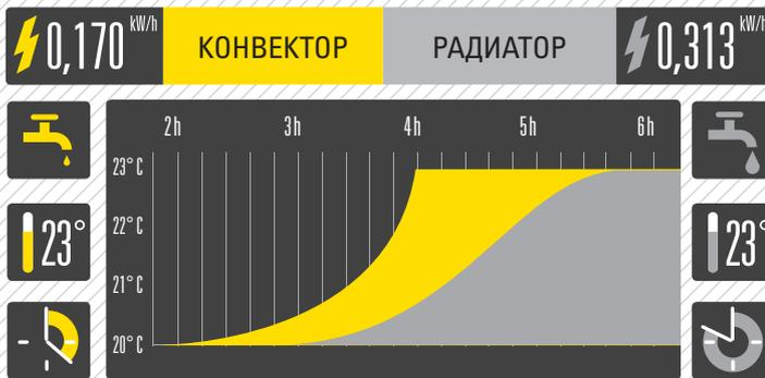
В отличие от радиатора конвектор обеспечивает экономию энергии и высокую динамику отопления/доохлаждения.
