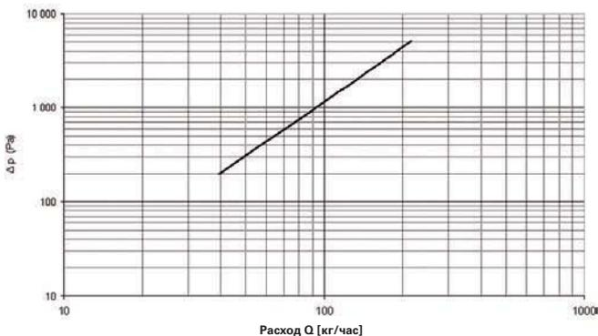
Потеря давления в нержавеющей трубке AZ 1/2" - 65 мм
