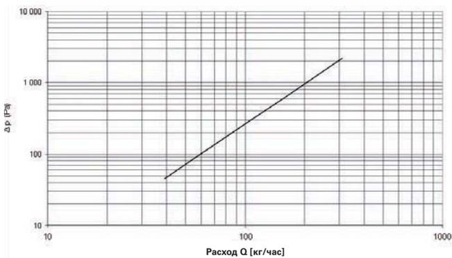
Потеря давления в двухтрубчатом теплообменнике MINIB трубка Cu Ø 12 мм
