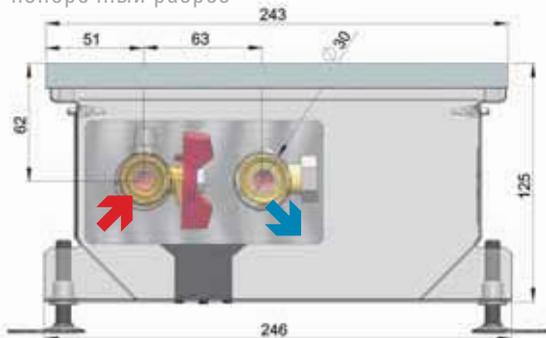
Базовый тип самого узкого внутрипольного конвектора с естественной конвекцией.
