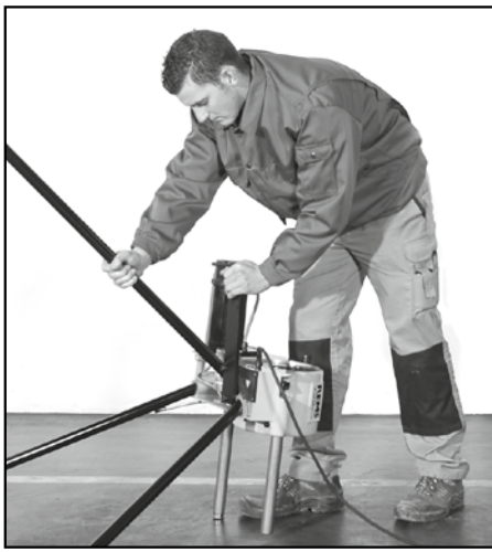
Fig. 1: RohrfüÙe einstecken Fig. 1: Inserting the tubular legs Fig. 1: Engager les pieds tubulaires Fig. 1: Infilare le gambe di supporto Fig. 1: Introducir las patas tubulares Fig. 1: Steunpoten insteken Fig. 1: Isättning av benen Fig. 1: Montering av rørben Fig. 1: Indstikning af rørben Kuva 1: Putkijalkojen asennus Fig. 1: Introduzir os pés tubulares Rys. 1: MontaÙ nòzek rurkowych Obr. 1: Trubkové nohy nastrčit Obr. 1: Rúrkové nohy nastrčit 1. ábra: Feltolní a csòlábakát Sl. 1: Utaknuti noge od cijevi Slika 1: Vstavite cevno podnoÙje Fig. 1: Introducere a picioarelor tubulare Фиг. 1: Вставить трубные ножки Εικ. 1: Τοποθέτηση των σωληνωτών ποδιών Resim 1: Boru tipi ayakların takılmaları Фиг. 1: Поставање на тръбните стойки 1 pav.: Vamzdinių kojų įstatymas Att. 1: Ievietot caurules galus Joonis 1: Torujalgade sissepanek
