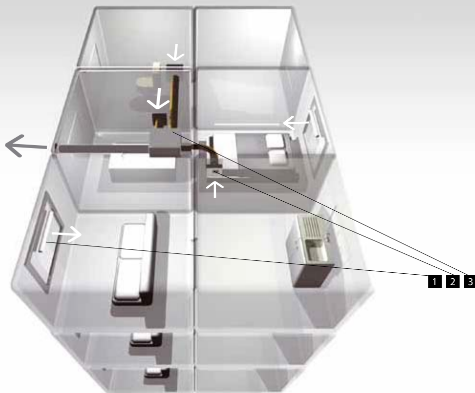
1. Приточные устройства. 2. Вытяжные устройства. 3. Вентилятор
