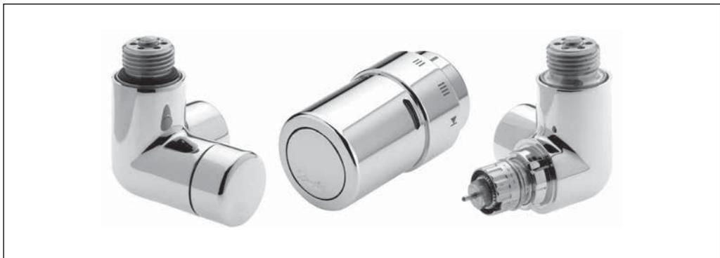
Терморегулирующий комплект X-tra™ специально разработан для дизайн-радиаторов и полотенцесушителей. Он состоит из клапана терморегулятора, термостатического элемента и запорного клапана с дренажной функцией. Инновационное самоуплотняющееся присоединение клапанов к радиатору осуществляется с помощью резьбы  $\frac{1}{2}$ ".
