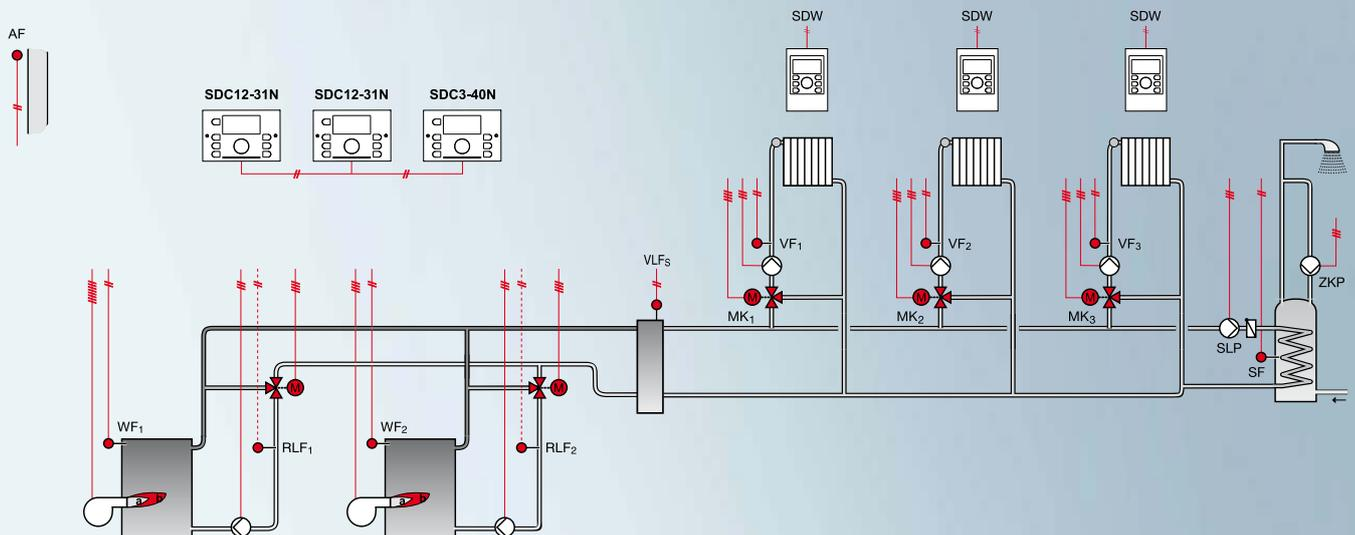
Данная схема наглядно показывает возможность управления небольшими коммерческими котельными при помощи нескольких контроллеров Smile объединенных по внутренней шине в единую сеть. Максимальная температура котловой воды может достигать 130 °С.
