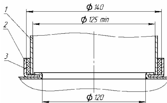
**Рисунок 8. Схема соединения аппарата с газоотводящей трубой**
