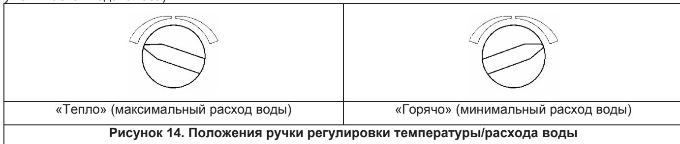
От положения ручки 5 зависит также значение расхода воды, при котором происходит включение и выключение основной горелки (см. примечание 2 п.3.2).
