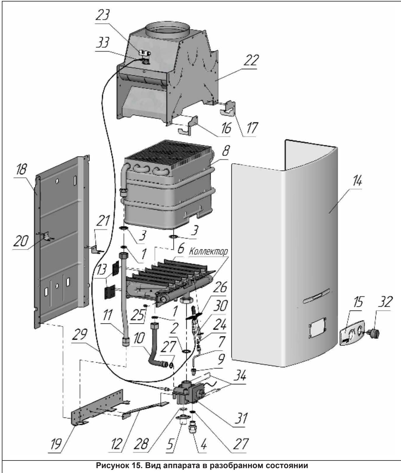
Рисунок 15. Вид аппарата в разобранном состоянии
