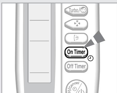
Таймер включения позволяет автоматически включить кондиционер через определенный промежуток времени. Вы можете установить значение этого промежутка равным от 30 минут до 24 часов.
