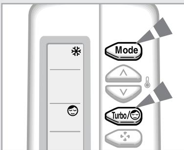
Таймер "сон" может использоваться при охлаждении вашей комнаты для того, чтобы кондиционер автоматически выключался по истечении шести часов.
