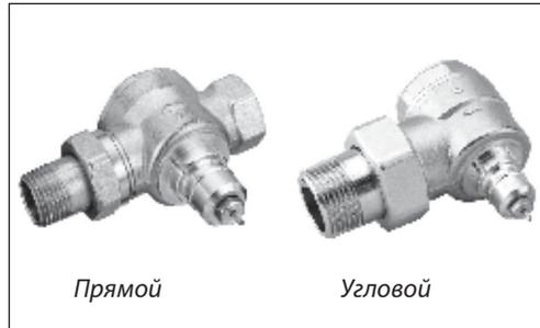
Регулирующий клапан RA-G обладает повышенной пропускной способностью и предназначен для применения в насосных однетрубных системах водяного отопления с замыкающими участками (байпасами).
