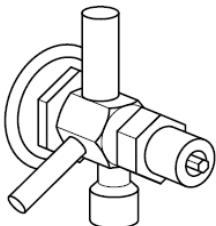
Снимите колпачок и поверните регулировочный винт отверткой в нужном направлении. Увеличив или уменьшив количество подаваемого хладагента, можно соответственно уменьшить или увеличить перегрев. Независимо от изменений тепловой нагрузки температура и давление в испарителе почти не изменяются.
