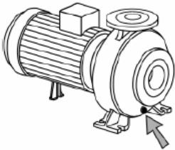
Проверка насоса. Через каждые 5000 часов работы насоса на панели управления появляется аварийный сигнал, при этом агрегат продолжает работать в нормальном режиме. Это сигнал о необходимости проверки насоса. Данная операция включает в себя очистку наружной поверхности насоса и проверку его состояния.
