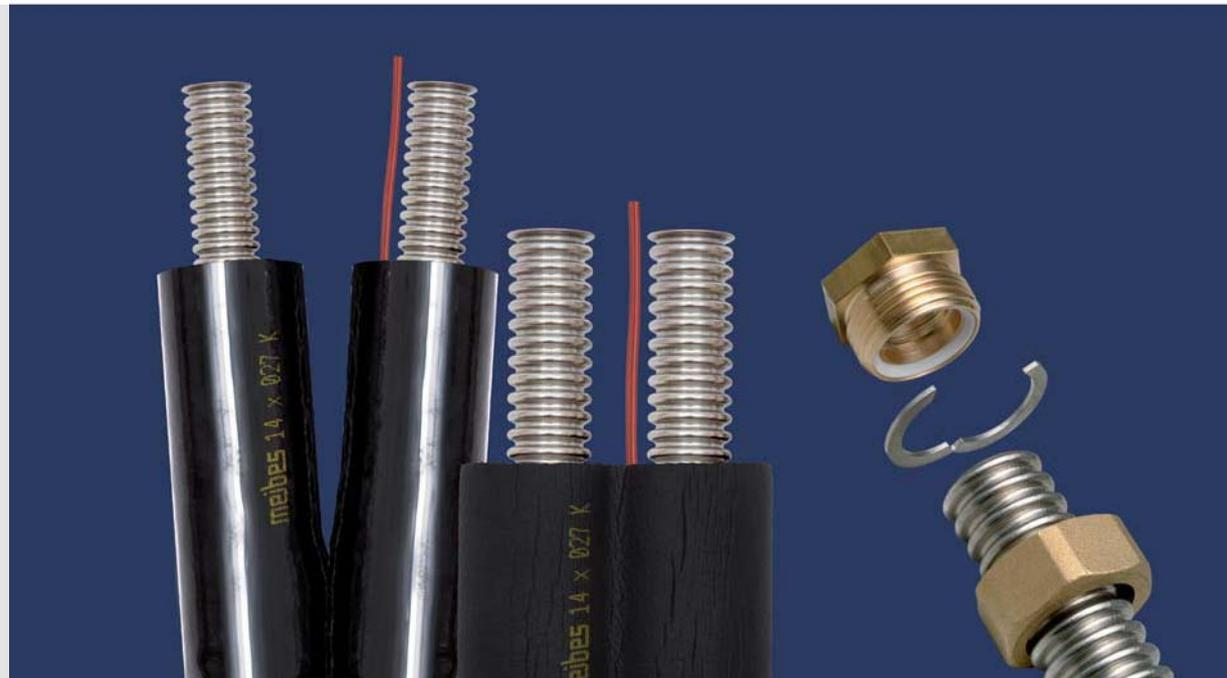
Двухпроводная система трубопроводов в каучуковой изоляции (возможно в защитной пленке) с перфорацией для легкого разъединения. Опционально с кабелем датчика солнечного коллектора
