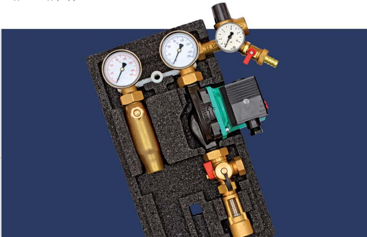
**В комплекте:** блочная теплоизоляция, группа безопасности, сливной кран, расходомер, разъем для подключения расширительной емкости, контактные термометры, отсечная арматура, насос 130 мм, подключения  $\frac{3}{4}$ "
