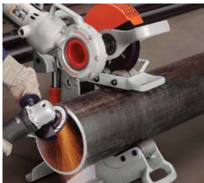
Модель 258 с роликовой опорой трубы в процессе использования для снятия фаски. Для этой операции рекомендуется привлекать двух операторов
