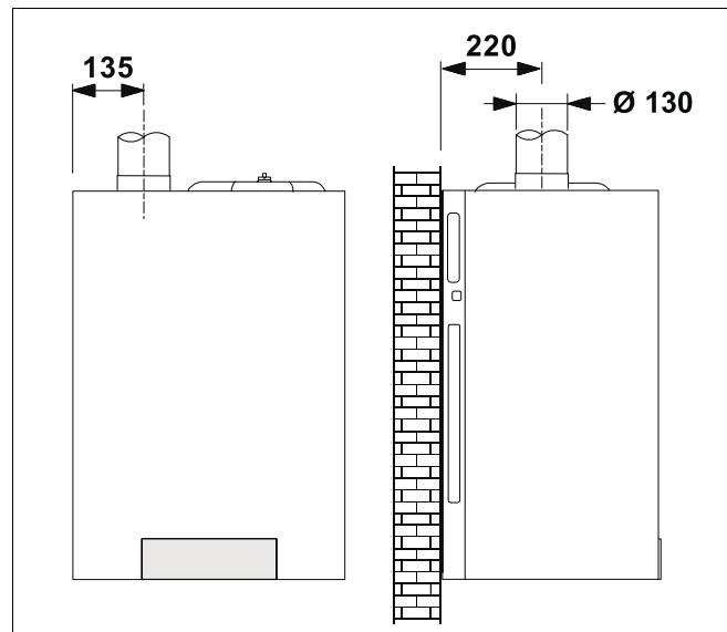
Рис. 11 Расположение дымовых каналов
