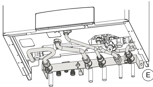
При использовании монтажной полки с подключениями нужно взять с монтажного шаблона положение кронштейна "E", см. рисунок 8.
