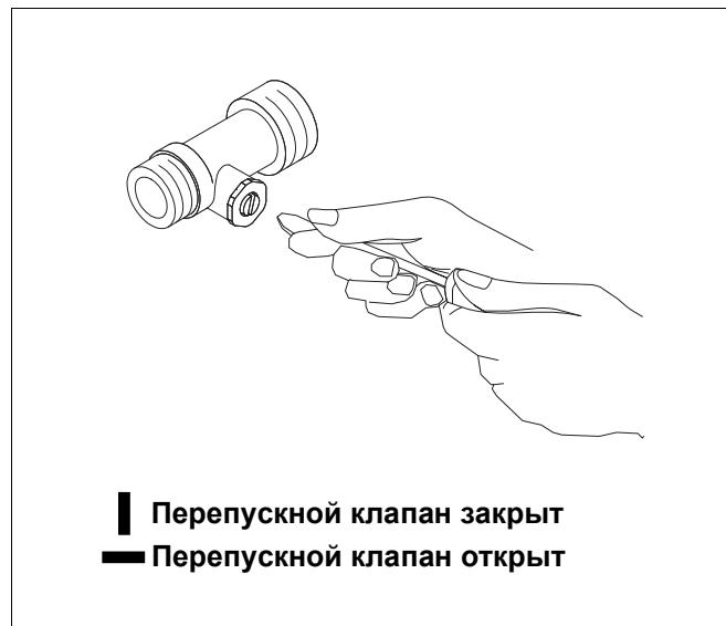
Рис. 29 Настойка перепускного клапана
