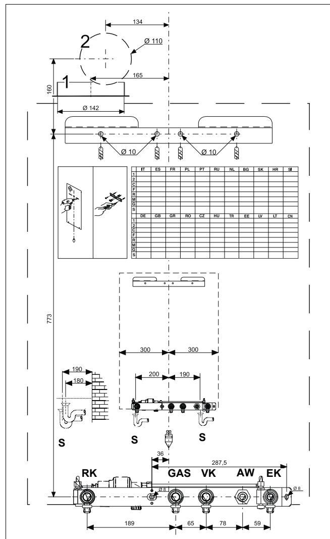
Рис. 7 Монтажный шаблон для подключения водонагревателя (размеры в мм)
