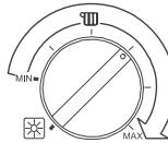
Если поворотный переключатель находится в пределах стрелки, то водонагреватель работает в режиме приоритетного приготовления горячей воды (если это требуется), и температура в отопительном контуре регулируется в диапазоне между минимальной 45 °C и максимальной 80 °C.
