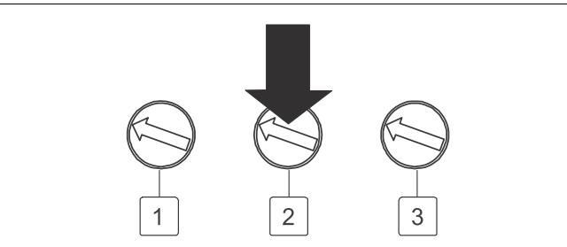
Рис. 44 Настойка минимальной мощности котла
