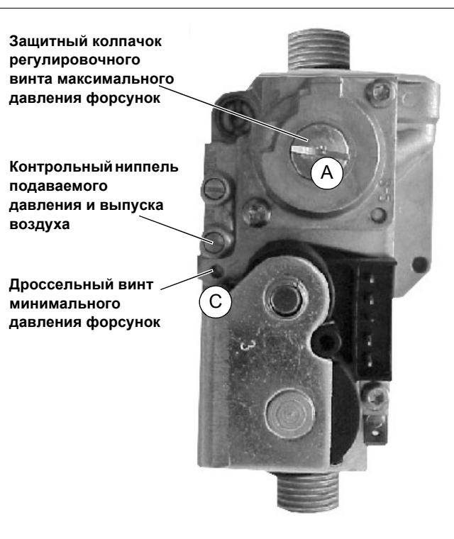
Рис. 43 Настойка давления форсунок
