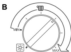
Для перевода газового циркуляционного водонагревателя в **зимний режим** можно установить переключатель (рис. 52, поз. **B**) в диапазоне по всей длине стрелки, указанной на верхнем рисунке. Концы стрелки соответствуют минимальной и максимальной температурам: 45 °C и 80 °C.
