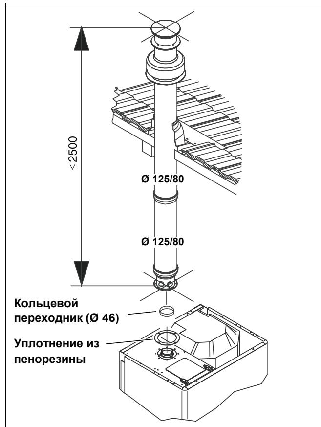
Рис. 20 Монтаж системы отвода дымовых газов
