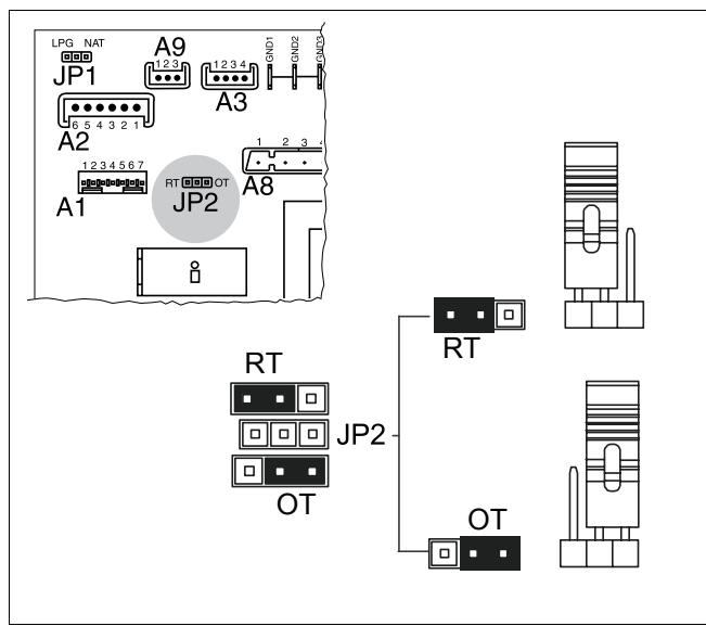
Рис. 38 Настойка комнатного термостата
