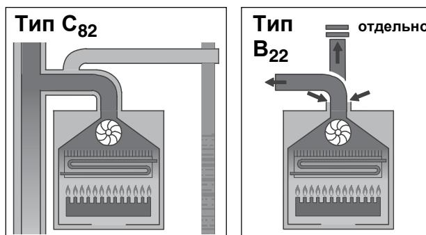
Рис. 12 Дымоходы и приточные воздуховоды для газовых установок типа В и С (размеры в мм)
