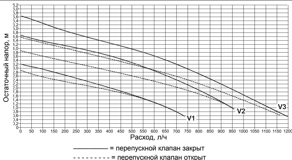
Рис. 30 Остаточный напор циркуляционного насоса
