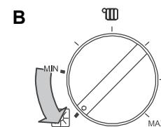
Для перевода газового циркуляционного водонагревателя в **летний режим** и только для приготовления горячей воды нужно перевести переключатель (рис. 52, поз. **B**) в положение ☀, при этом температура горячей воды настраивается переключателем (рис. 52, поз. **C**).
