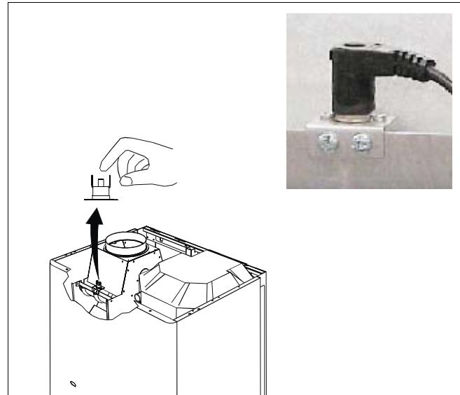
Рис. 10 Система контроля дымовых газов
