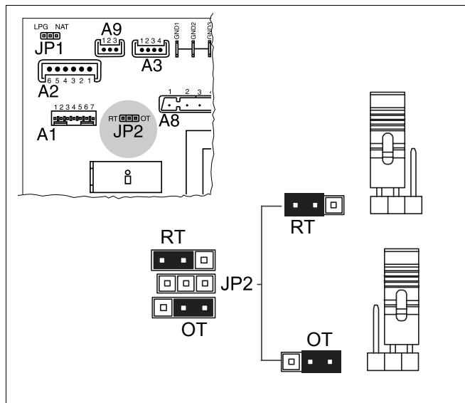
Рис. 34 Подключение комнатного терmostата с позициями включения/выключения (RT) или с плавной регулировкой (OT)
