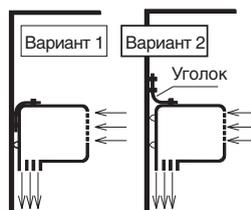
Уголки на стене можно закрепить отогнутой частью вниз (вариант 1) или отогнутой частью вверх (вариант 2). Уголки, шурупы, болты, шайбы входят в комплект монтажных частей.
