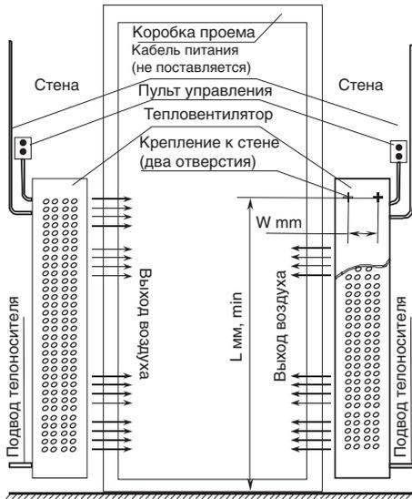
На задней стенке завесы имеются две пары отверстий с прорезами под шурупы (одна пара – для установки слева от проема, другая – для установки справа).
