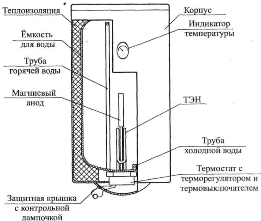
Рисунок 1 – Устройство водонагревателя
