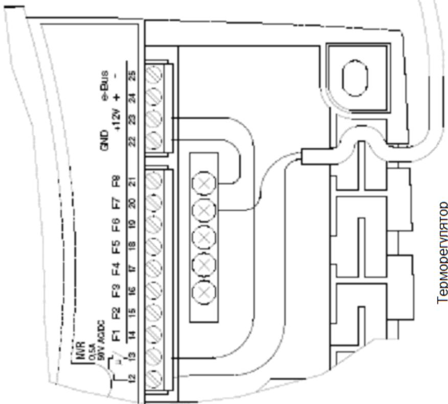
Монтажная схема: соединительное реле
