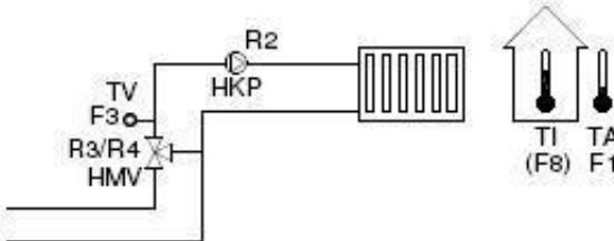
Например: конфигурация регулятора 2 с его функциями: 2. ступень горелки, циркуляция котла и повышение температуры обратного потока
