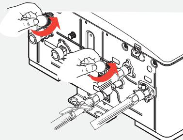
3 Снимите фильтр ①, откручивая его против часовой стрелки с помощью монеты. **Осторожно, возможно, оставшийся теплоноситель горячий.**
