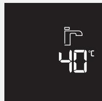
2 При непрерывном нажатии кнопки повышения температуры температура поднимется до 47°C, для дальнейшего повышения необходимо нажимать кнопку однократно до достижения желаемой температуры.
