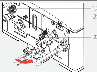
2 Снимите фильтр ГВС ③ , откручивая его против часовой стрелки с помощью монеты.
