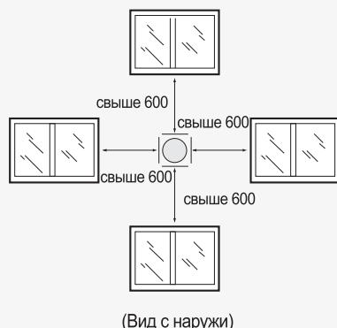
• Расположение дымохода относительно стен и потолка (Един измер. mm)
