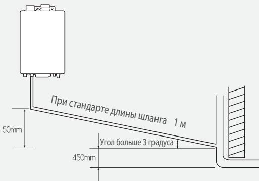
· При использовании отводного трубопровода в помещении.
