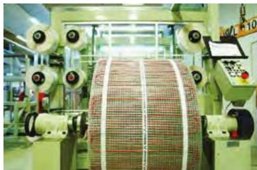
Автоматическая линия по производству нагревательных матов
