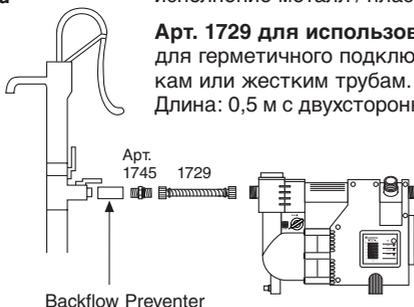
**Арт. 1729** для использования на всасывающей стороне для герметичного подключения насоса к напорным источникам или жестким трубам.
