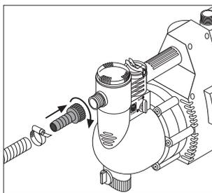
Привинтите всасывающую гарнитуру GARDENA (Арт. 1411 / 1418) на всасывающую сторону насоса и плотно затяните ее вручную, пока уплотняющее кольцо не запрессуется. Теперь опустите всасывающий шланг в перекачиваемую среду.
