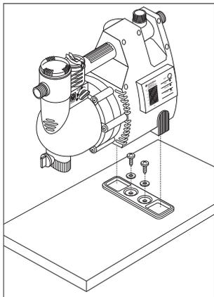
Для того, чтобы устойчиво установить насос и защитить его от сдвига, привинтите прилагаемую плиту крепления к подходящему основанию.
