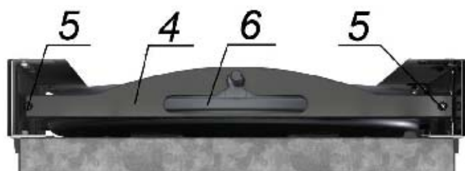
Рис. 21. Демонтаж расширительного бака
