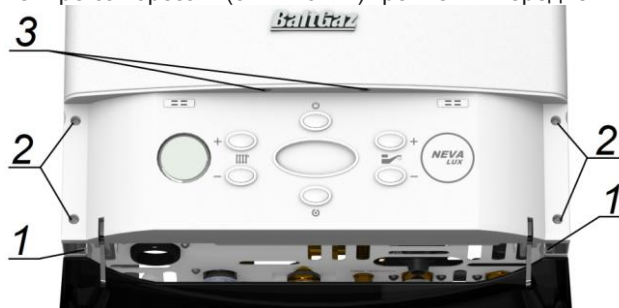
Рис. 14. Демонтаж облицовки и передней панели
