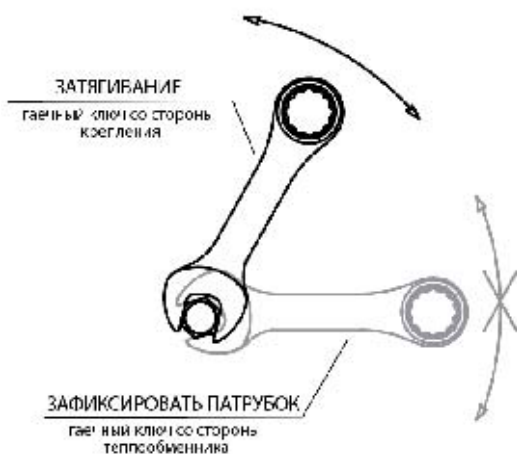
Рис. 5. Подключение к системе подачи теплоносителя
