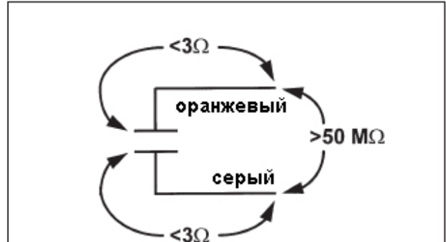
РИСУНОК 22. Проверка целостности и утечек Отсоединить провода электрода и измерить сопротивление и непрерывность, как показано. При проверке сопротивления между проводами электрода сенсор должен быть сухим. В сенсоре 404-17 (корпус из нержавеющей стали) серый провод (внешний электрод) является общим для корпуса сенсора. В сенсоре 404-16 (корпус из ПВХ) нельзя выполнять контроль непрерывности. Электроды запрессованы в корпус сенсора, и труднодоступны.
