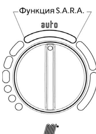
Данная функция позволяет автоматически выбирать температуру теплоносителя в зависимости от меняющейся тепловой нагрузки. Функция активируется только при наличие комнатного терmostата. Включение и отключение данной функции сопровождается частым миганием светового индикатора зеленого цвета.
