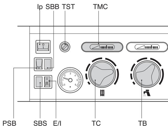
В случае блокировки ввиду срабатывания предохранительного теплового термостата, красная лампа (SBS) горит, и термометр котла (TMC) ( $T \geq 110^{\circ}\text{C}$ ), для восстановления условий запуска:
