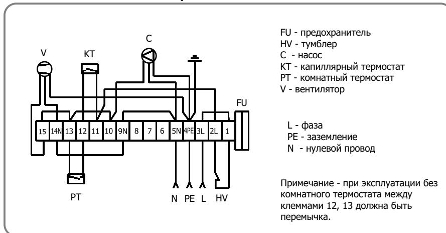
**Электрическая схема подключения всех вариантов
