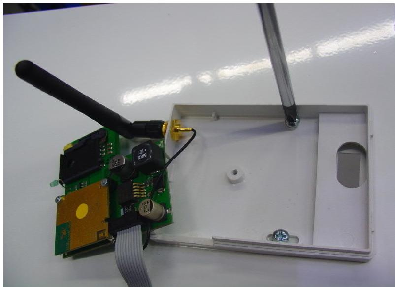
Plastovou krabičku přišroubujte dvěma šrouby do připravených otvorů v krytu kotle. Krabička musí být otočena tak, aby LED dioda po smontování směrovala k obsluze.
