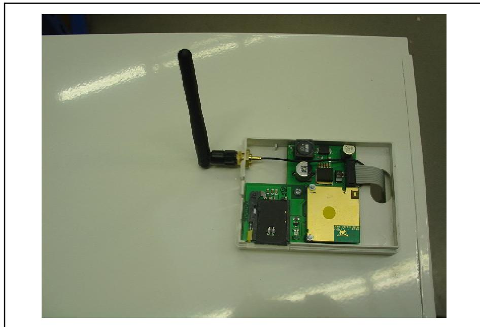
Protáhněte plochý vodič otvorem v krytu kotla. Nasadte kryt kotle a připojte vodič do konektoru v GSM modemu. Zavřete plastovou krabičku víkem.
