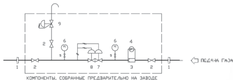
Сх.01 Группа редуцирования давления на одной линии
