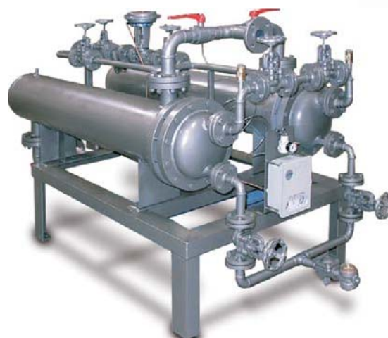
Пример: станция подогрева мазутного топлива
