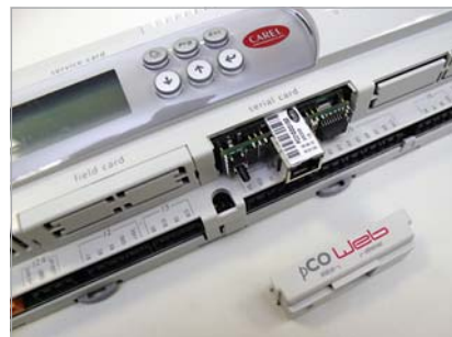
Carel pCOWeb – BACnet Ethernet шлюз для контроллеров семейства pCO
