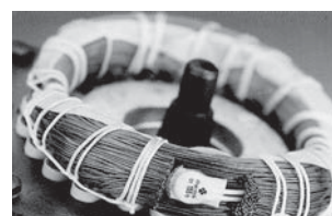
Рис. 23 Термовыключатель, встроенный в обмотку электродвигателя
