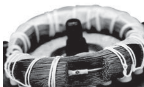
Рис. 21 Датчик РТС, встроенный в обмотку
