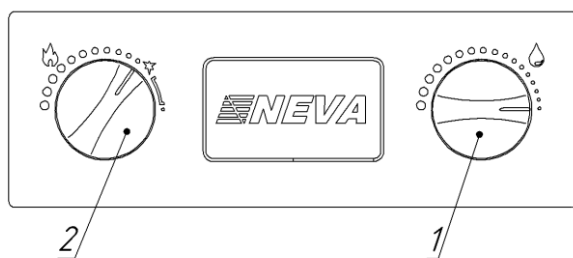
а) Ручки регулировки расхода воды 1 и расхода газа 2 в положении « Минимальный расход »
