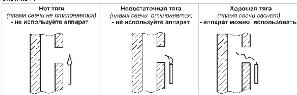
Рисунок 7. Способ проверки тяги в дымоходе
