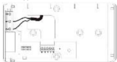
Соедините 2 провода системы отопления или охлаждения к контактным зажимам 1 и 2, как показано на рисунке. Можно присоединить к контактам гибких
