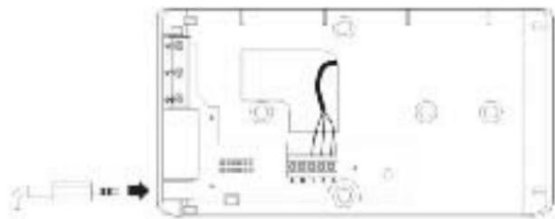
Соедините 3 провода телефонного активатора к контактным зажимам 1, 2 и 3, как показано на рисунке. Альтернативно, активатор может быть подключен посредством гнездового соединителя в 3.5 мм с левой стороны.
