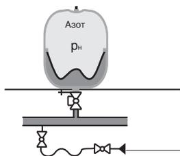
**Медленно открыть запорную арматуру**, через кран для слива удалить воздух из расширительной линии, после чего кран для слива закрыть.
