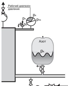
Включить теплогенератор, нагреть воду в системе до максимального значения температуры в подающей (при нагревании воды из нее выделяется растворенный воздух).
