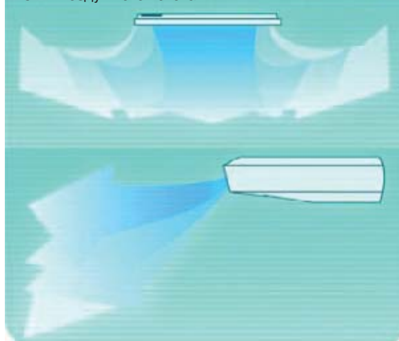
Автоматические жалюзи и широкий угол распространения воздушного потока
