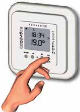
2. Подтвердить заданную температуру кнопкой
