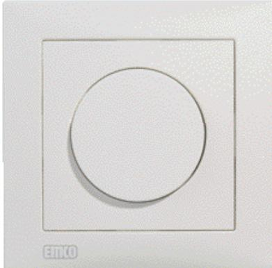
Электронный потенциометр emco DZR предназначен для плавного регулирования числа оборотов вентиляторов в конвекторах emcotherm посредством выходного сигнала в интервале от 0 до 10 В.
