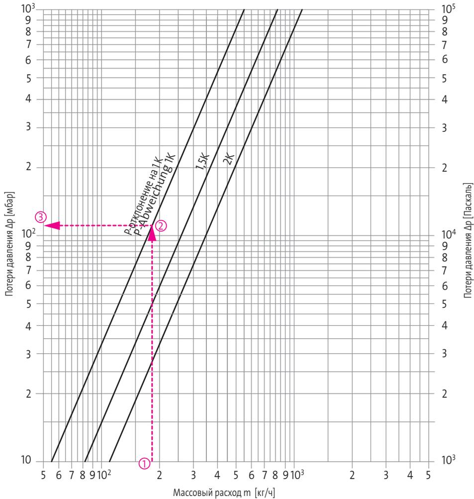
100 мбар = 10 000 Па  $\approx$  1 000 мм.вод.ст.**Пример расчета**
