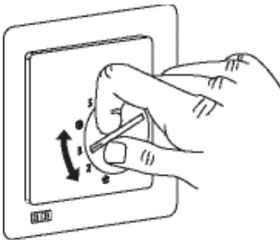
Предусмотрено 6 ступеней настройки диапазонов температур с помощью ручки настройки (см. рис. слева). Контрольным цифрам на шкале ручки настройки соответствуют следующие диапазоны температур.
