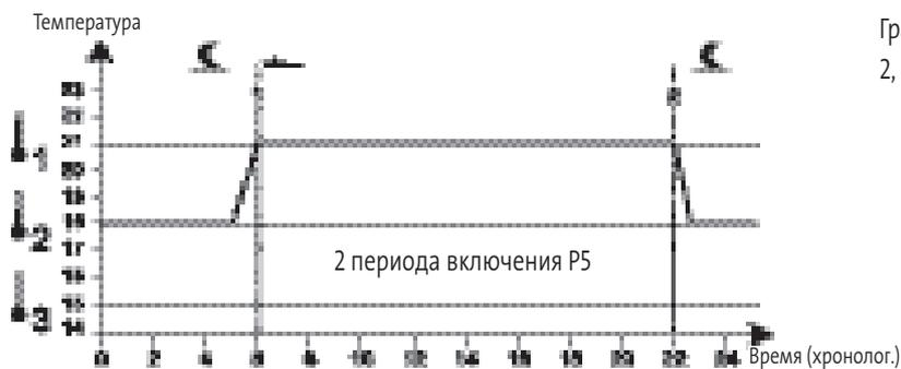
График суточного хода температуры при 2, 4, 6 периодах включения за сутки
