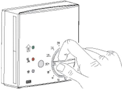
Требуемую температуру в помещении (заданную температуру) можно настроить с помощью ручки настройки.
