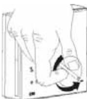
1. Повернуть ручку настройки против часовой стрелки в направлении минимального значения до упора.
