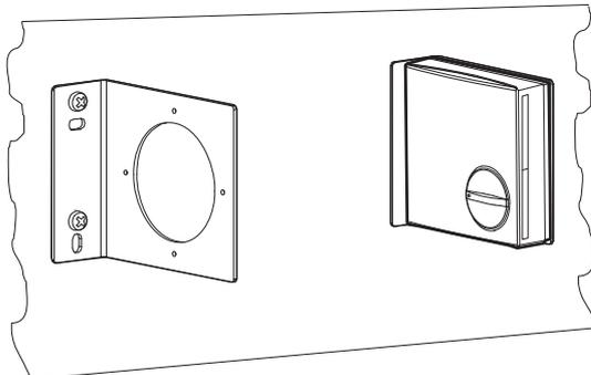
Открывать и закрывать корпус следует в соответствии с этапами монтажа, описанными выше. Однако для крепления устройства основание корпуса соединяют подходящими винтами с монтажным уголком.
