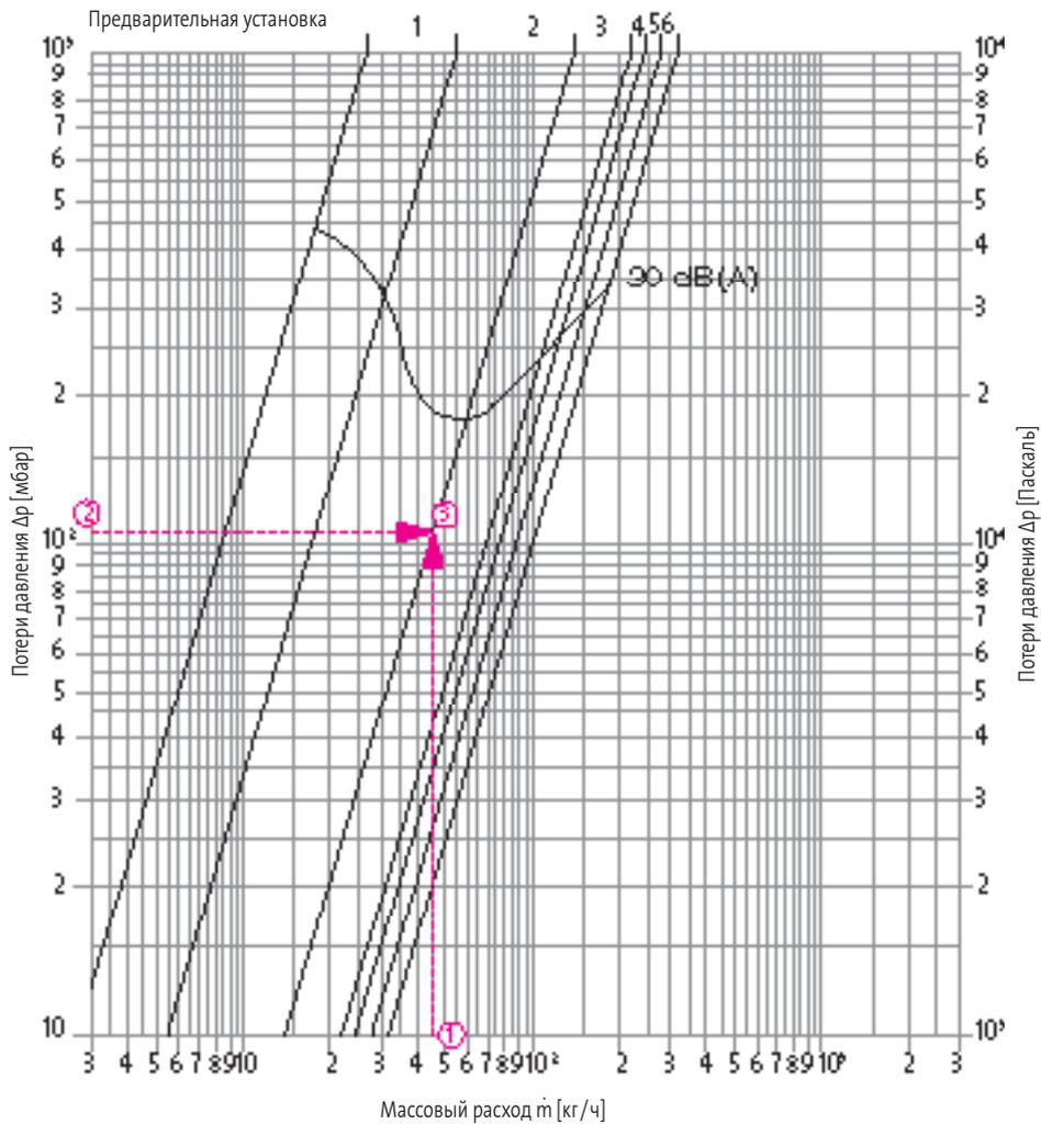
Допуски по расходу в зависимости от предварительной установки.
