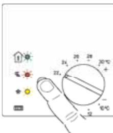
2. Нажать и удерживать нажатой не менее 5 секунд клавишу присутствия. После этого должны начать мигать все три светодиода.
