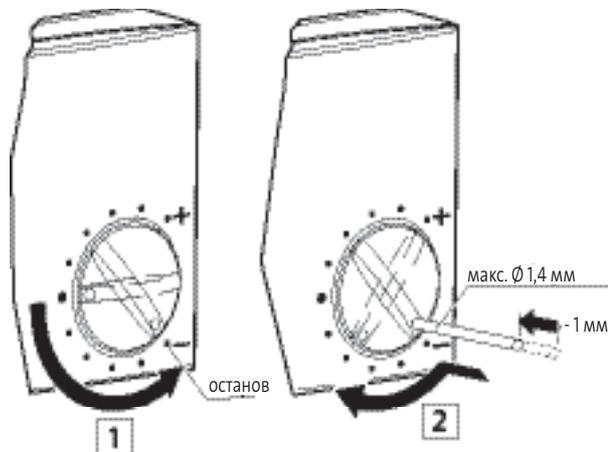
1. Повернуть ручку настройки против часовой стрелки в направлении минимального значения до упора (-).
