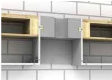
Перекрытие с деревянными балками с подшивным потолком
