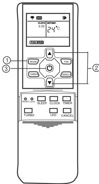
Когда вы устанавливаете автоматический режим работы кондиционера, кондиционер выбирает необходимый режим работы (охлаждение, обогрев или вентиляция) в зависимости от установленной пользователем температуры на пульте ДУ, и температуры в помещении. Если вам необходимо выключить кондиционер нажмите кнопку (ON/OFF).
