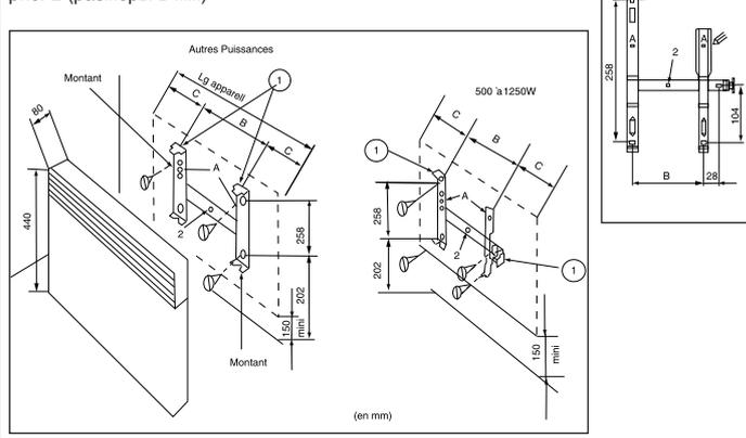
– переставить кронштейн так, чтобы нижние установочные отверстия аппарата и отмеченные Вами точки совпали;
