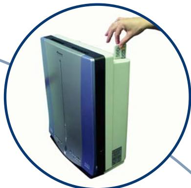
Для исключения возможности пуска прибора детьми в ваше отсутствие или непреднамеренного изменения значений установленных параметров, предусмотрен электронный «замок». Он активизируется и отключается с помощью пульта управления. Об активизации замка сообщает горящий красный светодиод пусковой клавише, расположенной на передней панели
