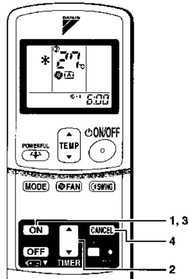
Удерживая в нажатом положении верхнюю или нижнюю части кнопки TIMER, вы ускоряете процесс установки времени.
