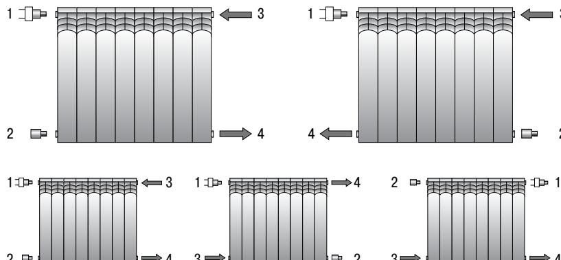
Обозначения: 1 - воздухоотводчик; 2 - заглушка; 3 - подача теплоносителя; 4 - выход теплоносителя
