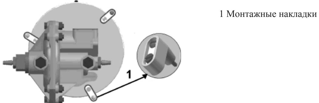
Рисунок 12: Настольный монтаж с помощью монтажных накладок MAG 115 Dif
