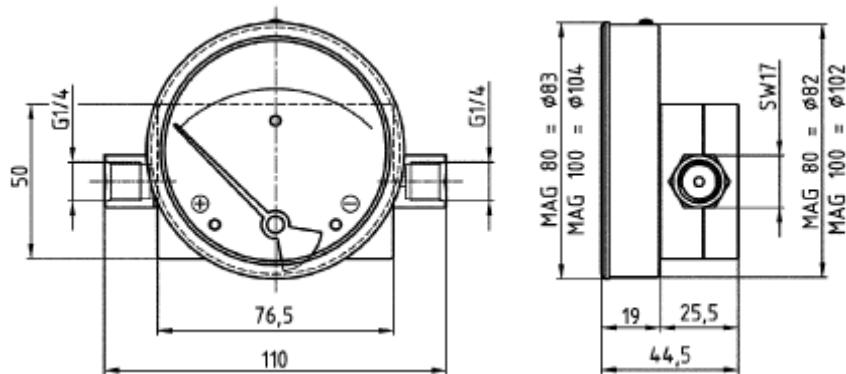
Рисунок 4: Соединение справа и слева, вид сбоку
