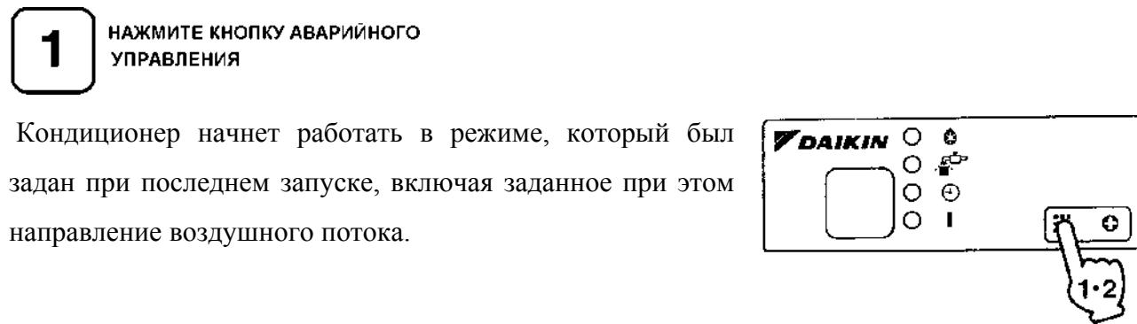
Кондиционер начнет работать в режиме, который был задан при последнем запуске, включая заданное при этом направление воздушного потока.
