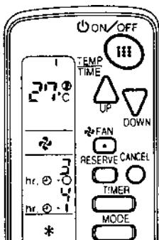
Если таймер запрограммирован на выключение кондиционера через 3 часа и включение кондиционера через 4 часа, то спустя 3 часа система выключится, а еще через час снова запустится.
