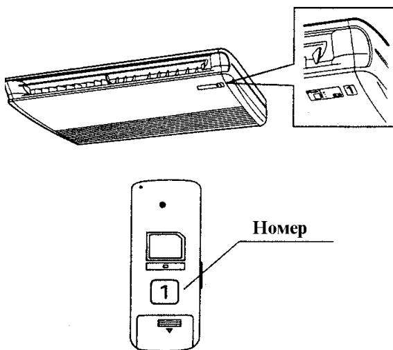
Внутренний блок может управляться только пультом, имеющим тот же номер: сигналы управления, излучаемые другим пультом, не принимаются. (Если номер не указан, он считается равным «1».)
