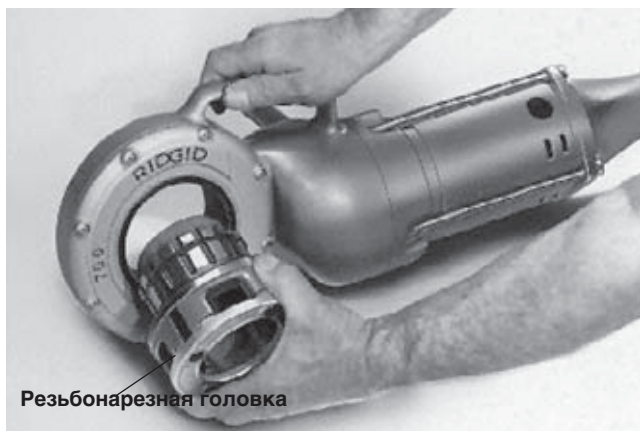
Рисунок 3 – Установка головки № 12-R с откидным верхом
