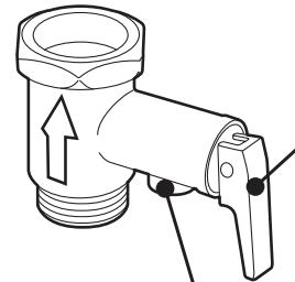
Рычаг предохранительного клапана
